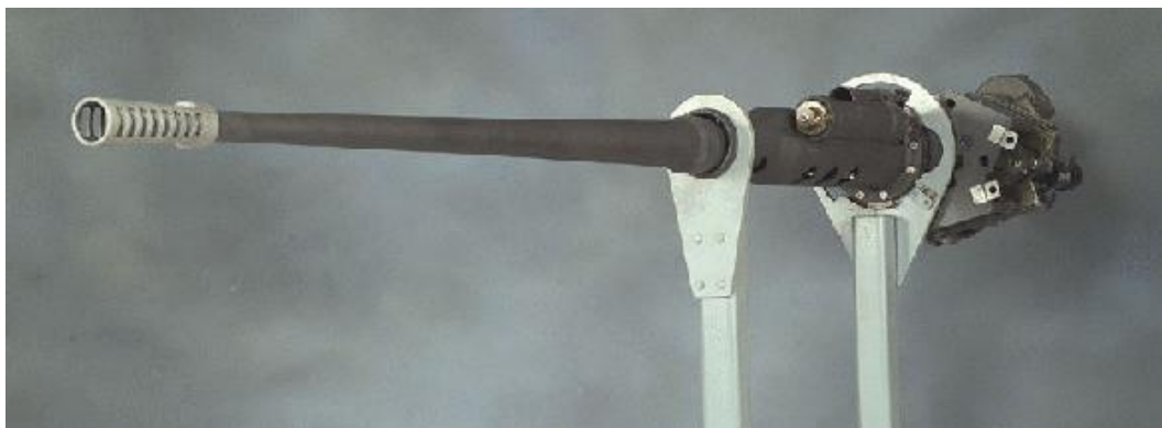
Рисунок 40. 25-мм автоматическая пушка M242 "Bushmaster"
